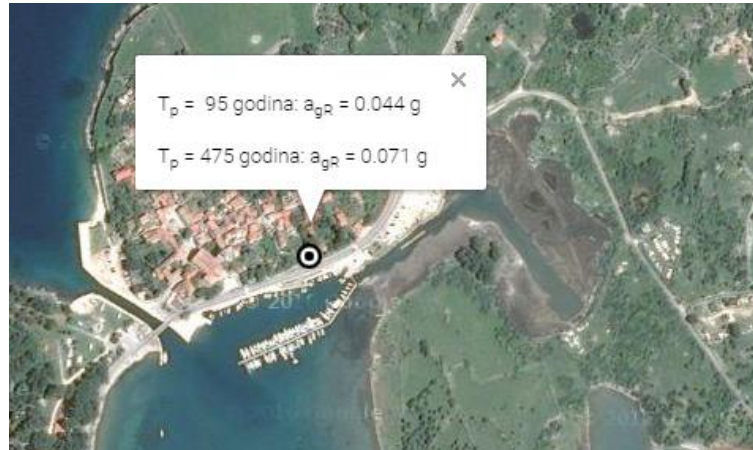
Slika 6. Horizontalna vršna ubrzanja tla tipa A ( a_{gR} ) za povratna razdoblja od T_p = 95 i 475 godina za lokaciju Luke Osor
